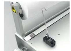
Vliesmangelschalter Fleece limit switch
