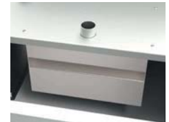
Einlaufverteiler Inlet distributor
